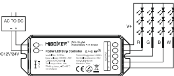
Schemat podłączenia RGBW
